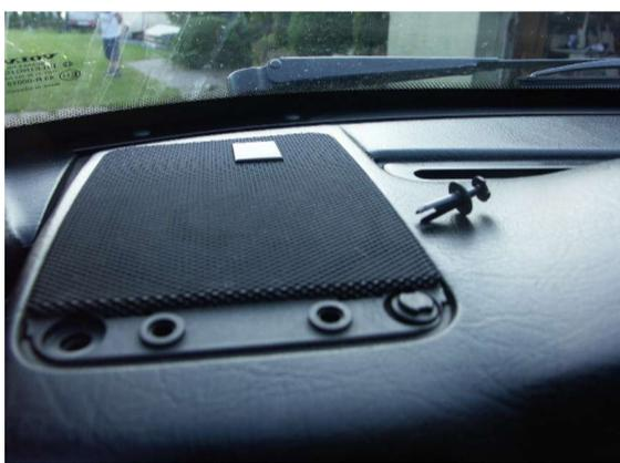
Jetzt läßt sich der ganze Dübel herausnehmen. Das ganze gilt für beide Dübel. Sind beide Dübel draußen hebt man nun die ganze Abdeckung mit dem Dreher oder Taschenmesser vorne bei den Dübellöchern hoch und zieht sie zu sich heraus. Beide Kabel am Lautsprecher abziehen und schon hat man die ganze Abdeckung samt Lautsprecher in der Hand.
